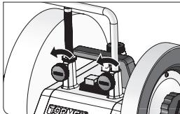
2. Se till att ratten för läsning av utstick (7.) och de båda rattarna till universalstödet är lossade.
