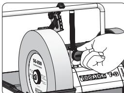
**2.** När du höjt universalstödet så att vinkelvisaren står på önskad slipvinkel, lås universalstödets rattar och ta bort vinkelställaren från universalstödet.
