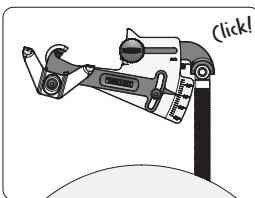
Fäst KS-123 Vinkelställare för knivar på universalstödet så du hör att hållaren för universalstödet (2.) knäpper fast.
