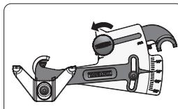
**2.** Assurez-vous que le bouton de verrouillage de la protubérance (7.) et les deux boutons sur les manchons du support universel sont desserrés.
