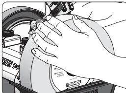
**1.** Poser un doigt sur chacun des trois pieds de référence (5.) en exerçant une légère pression. Relevez le support universel jusqu'à ce que l'indicateur d'angle (4.) pointe vers l'angle d'affûtage souhaité sur l'échelle d'angle (3.). Veillez à ce que les trois pieds horizontaux reposent contre la meule lors de cette étape.
