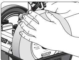
**1.** Legen Sie einen Finger mit leichtem Druck auf jeden der drei Referenzschenkel (5.). Heben Sie die Universalstütze an, bis die Winkelanzeige (4.) auf den gewünschten Schärfwinkel auf der Winkelskala (3.) zeigt. Achten Sie darauf, dass bei diesem Schritt alle drei horizontalen Schenkel an der Schleifscheibe anliegen.
