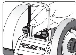
**3.** Abaissez le support universel un peu plus bas que ce dont vous pensez avoir besoin, car il sera plus facile de régler l'angle en relevant le support universel. Laissez les boutons du support universel desserrés.
