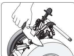
Insérez la lame de couteau avec le bord **centré** dans le support de bord en forme de V (6.) avec le dispositif pour couteaux sur le côté **droit** du dispositif de réglage d'angle.
