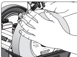
**1.** Sätt ett finger på vardera av de tre referenspinnarna (5.) med ett lätt tryck. Höj universalstödet tills vinkelvisaren (4.) pekar på önskad slipvinkel på vinkelskalan (3.). Kontrollera att alla tre referenspinnar ligger an mot slipskivan i detta läge.
