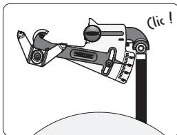
Fixez le dispositif de réglage de l'angle des couteaux KS-123 au support universel en l'encliquetant en place.
