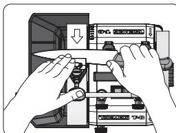
**3.** Die Universalstütze ist nun auf die richtige Höhe für den gewünschten Winkel des Messers in der Vorrichtung für Messer eingestellt, und Sie können mit dem Schärfen Ihres Messers beginnen. Der KS-123 Messerwinkelsetzer ist selbsteinstellend für den Schleifscheibendurchmesser.
