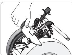
Sätt in knivbladet med eggen **mitt i** det V-formade egg-anslaget (6.) med knivjiggen på **höger** sida om vinkelställaren.
