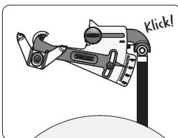
Befestigen Sie den KS-123 Messerwinkeleinsteller an der Universalstütze, indem Sie die Halterung für die Universalstütze (2.) einrasten lassen.
