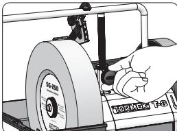
**2.** Après avoir soulevé le support universel de manière à ce que l'indicateur d'angle pointe vers l'angle d'affûtage souhaité, verrouillez les boutons du support universel et retirez le dispositif de réglage de l'angle des couteaux KS-123 du support universel.
