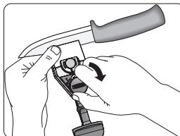
1. Fäst kniven i din knivjigg enligt dess instruktion och lägg dem åt sidan.
