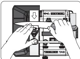
**3.** Le support universel est maintenant réglé à la bonne hauteur pour l'angle souhaité du couteau dans le dispositif pour couteaux, et vous pouvez commencer à affûter votre couteau. Le dispositif de réglage de l'angle des couteaux KS-123 s'ajuste automatiquement au diamètre de la meule.
