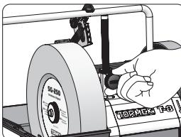
**2.** Nachdem Sie die Universalstütze so weit angehoben haben, dass der Winkelanzeiger auf den gewünschten Schärfwinkel zeigt, verriegeln Sie die Schrauben der Universalstütze und nehmen Sie den KS-123 Messerwinkelsetzer von der Universalstütze.
