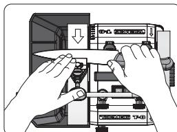
**3.** Universalstödet är nu inställt till rätt höjd för önskad slipvinkel på kniven i knivvijgen, och du kan börja slipa din kniv. KS-123 Vinkelställare för knivar är självjusterande för slipskivans diameter.
