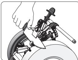
Setzen Sie die Messerklinge mit der Schneide **zentriert** in die V-förmige Schneidenauflage (6.) ein, wobei sich die Vorrichtung für Messer auf der **rechten** Seite des Winkeleinstellers befindet.
